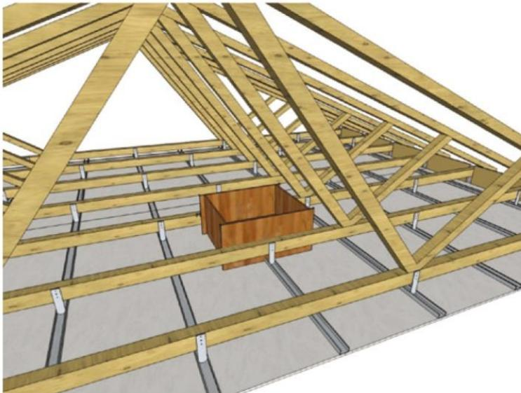
Figure 6 – Traitement des trappes d'accès
