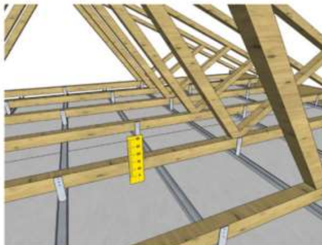
Figure 7 – Repérage de la hauteur d’isolant à souffler
