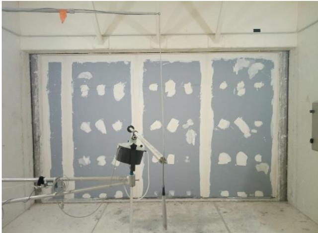
Cloison en essai dans le local d'émission
