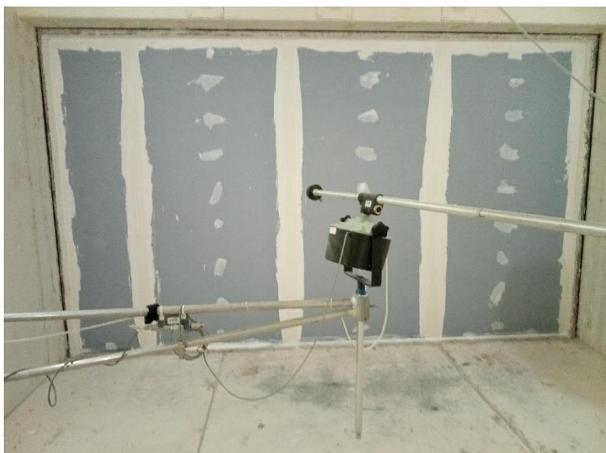
Cloison en essai dans le local d'émission
