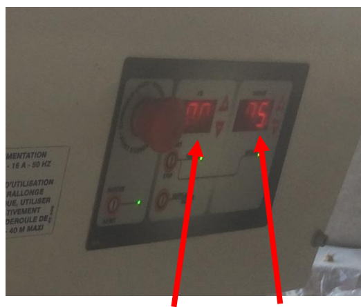
Réglage de l'air et de la matière
